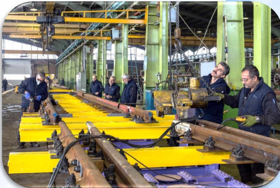
خط تولید سوزن ریلی شرکت گسترش صنایع ریلی ایران (ایرید)
